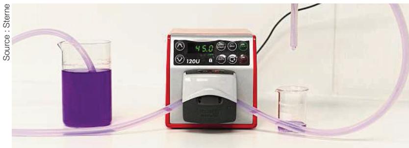
Sterne a comparé les performances de tubes en silicones conventionnels et UV en utilisant une pompe péristaltique Watson-Marlow.
