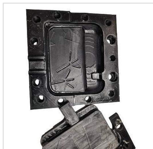
Moule en plastique imprimé en 3D pour l'injection en basse pression de pièces en silicone.
