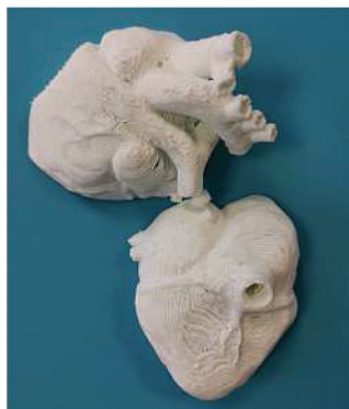
Cœur imprimé en 3D avec la technique SiO Shaping de Sterne
